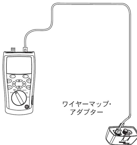
図 2 対撚り線ネットワークケーブルのオートテスト接続
