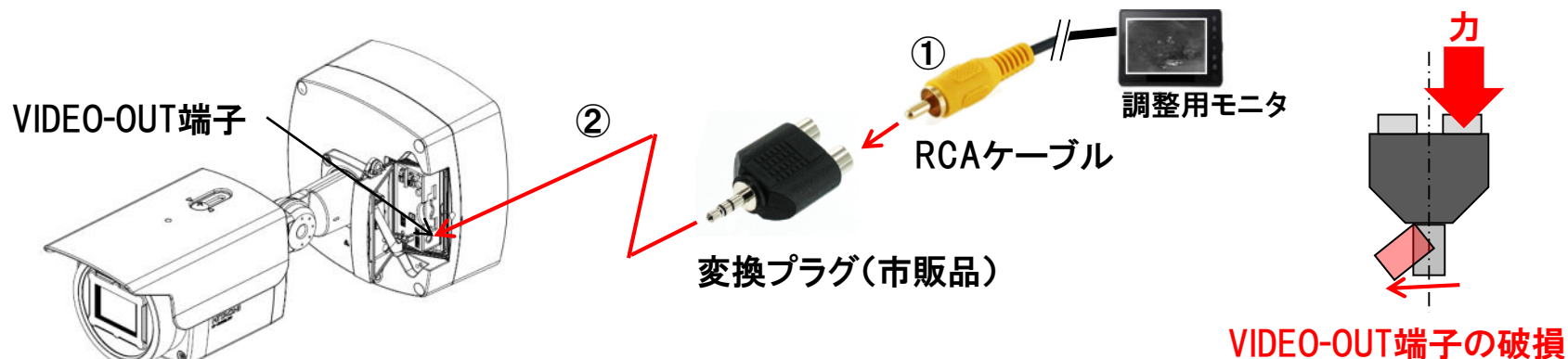
図1-(2) VIDEO-OUT端子へのプラグ挿入注意
