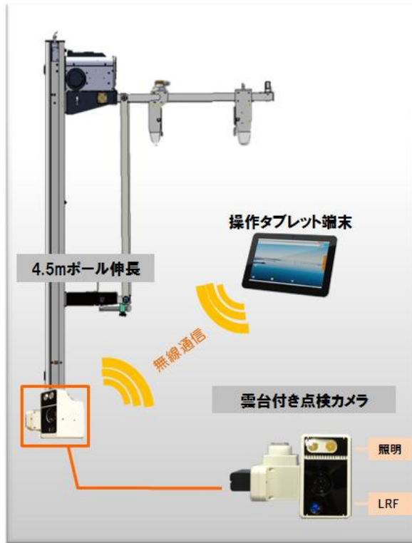
図1 橋梁点検ロボットカメラ懸垂型システム構成
